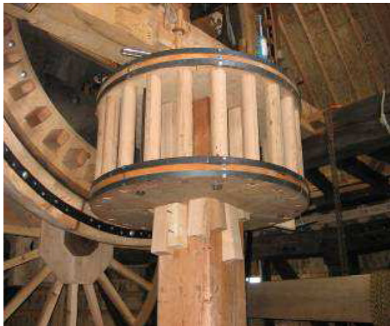
Schijfloop met ronde staven die aansluit op de kammen van een bovenwiel
